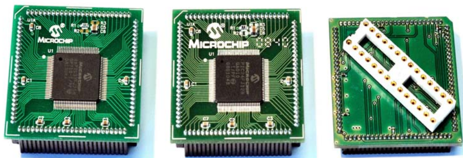
Abbildung 2.6: Fertige PIM-Sockel von Microchip; rechts eigener PIM-Sockel
