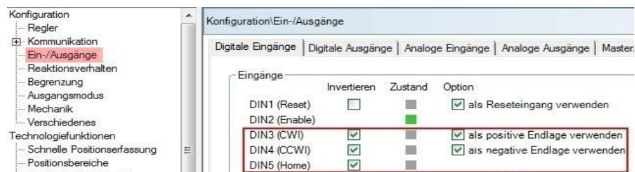
Abbildung 25: Konfiguration der digitalen Eingänge
