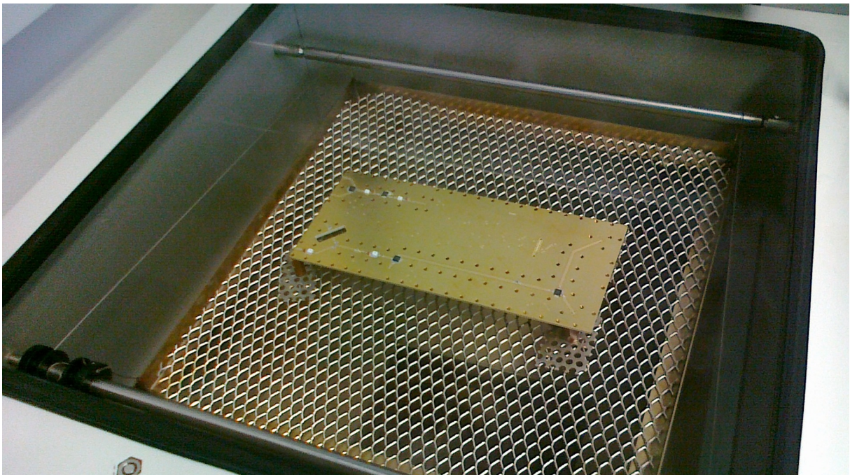
Abbildung 9.2.1: Bestückte Platine im Reflow-Ofen
