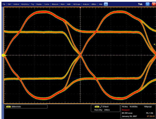
Abbildung 4.14: Augendiagramm eines 10 MBit Ethernetsignals am Eingang des Zirkulators
