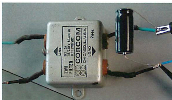
Abbildung 29: Filter und Kondensator
