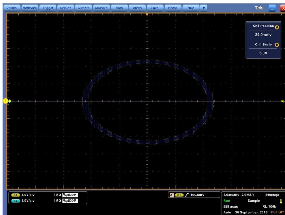
Abbildung 28: XY-Diagramm Allpass 90°
