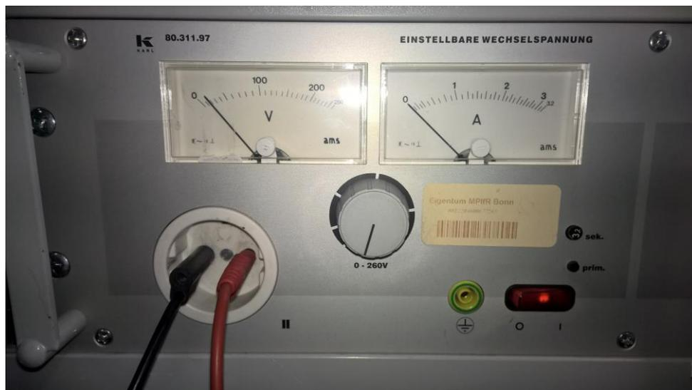
Abbildung 17: Drehtrafo für 230V Netzanschluss
