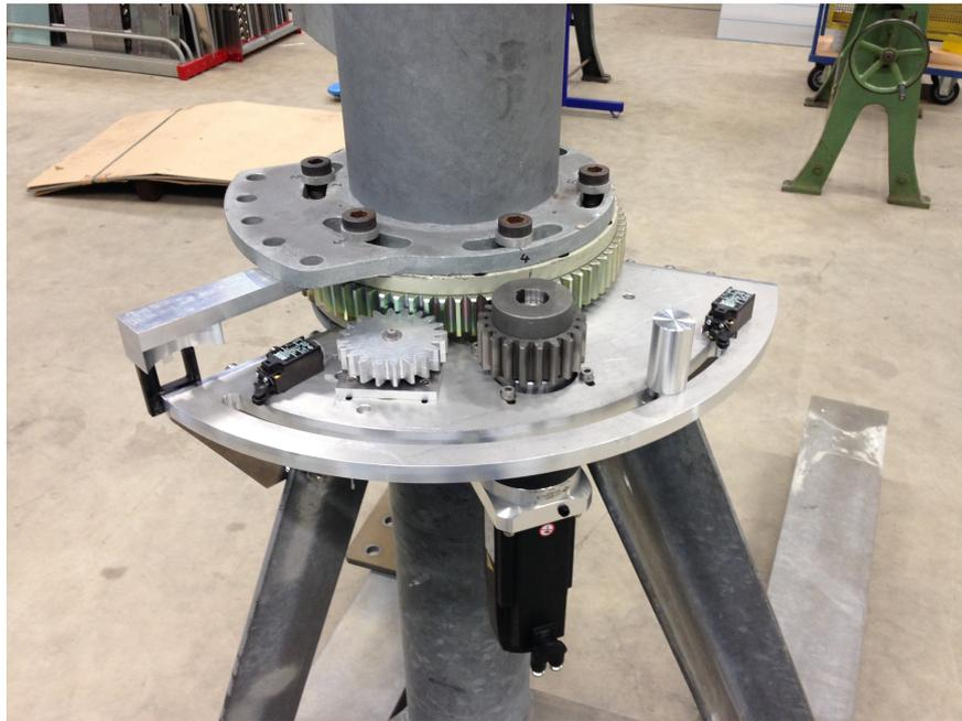
Abbildung 21: Aufbau Azimut Antrieb mit Winkelmesssystem
