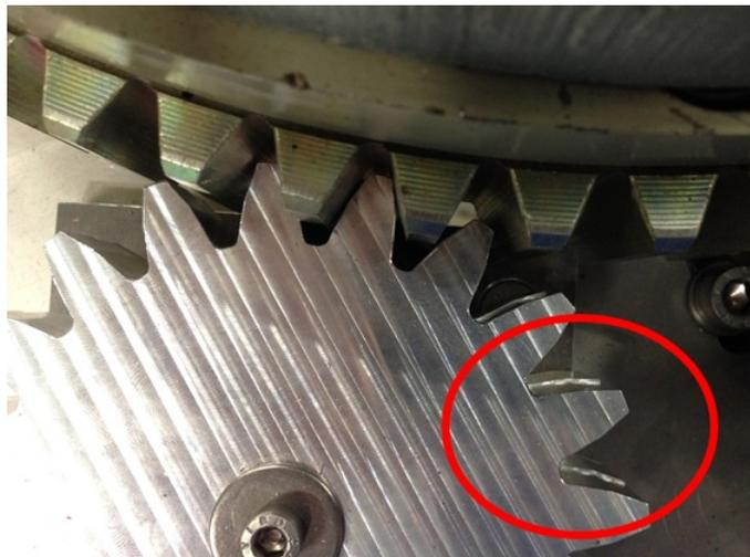
Abbildung 22: Federverspanntes Zahnrad
