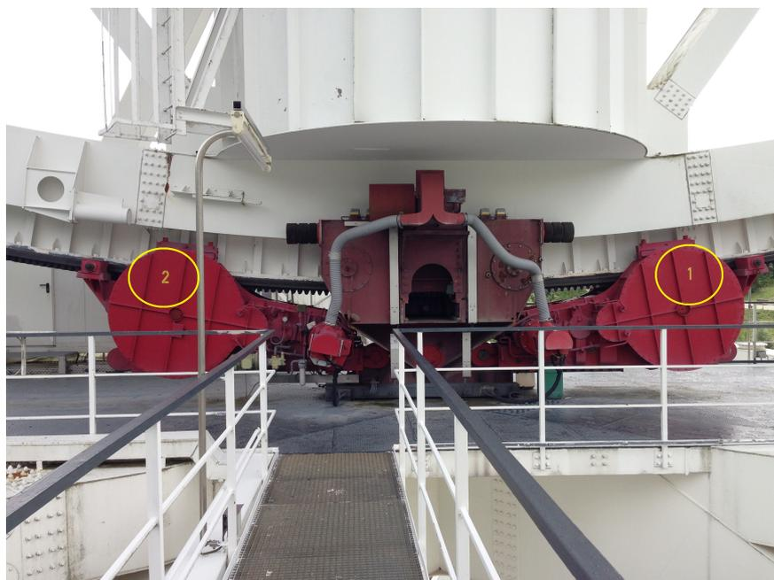
Abbildung 14: Elevationsantrieb 100-Meter-Radioteleskop in Effelsberg
