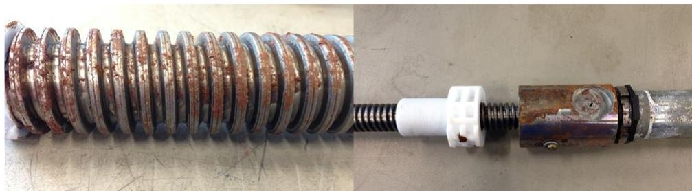
Abbildung 11: Demontierter Elevationsantrieb
