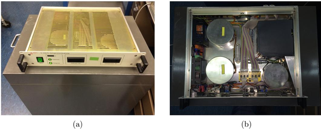
**Abbildung 2.11:** Im Einsatz befindliche Refrigeratorsteuerung, (a) Außenansicht, (b) Innenansicht
