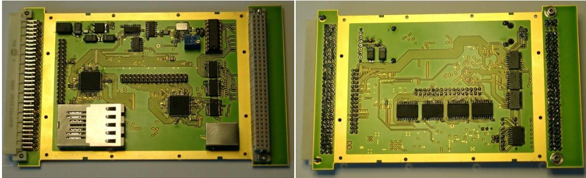
Abbildung 4.14: Vorder- und Rückseite RxBussystem
