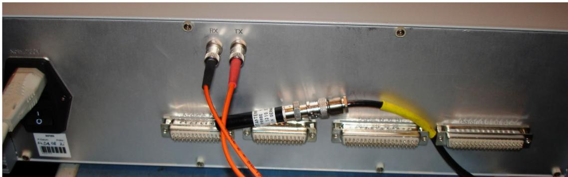
Abb. 100: Messung mit Nahfeldsonde an Sub-D-Anschlüssen unterhalb des Lichtwellenleiteranschlusses
