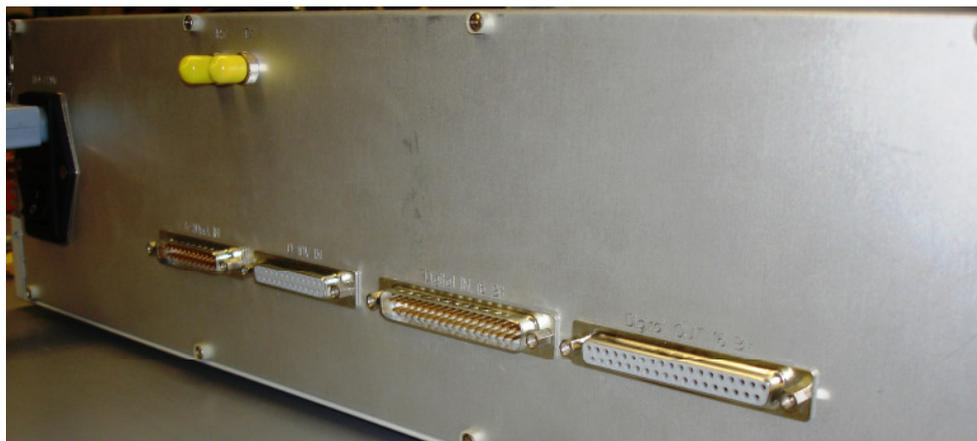
Abb. 71: Einschub-Rückplatte mit Sub-D-, Lichtwellenleiter- u. Netzanschluss
