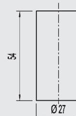
Gehäuse bei Genauigkeit 0,5 %
