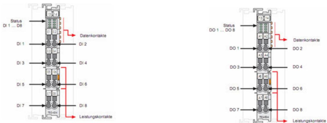
Abb. 22: 8-Kanal Digital Eingangs-(links) und Ausgangsklemmen (rechts) jeweils 5/12V 0,2ms [ 14]
