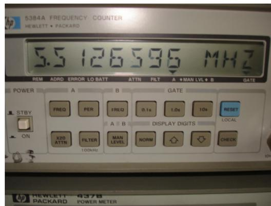
Abb. 43: Ausgabe der Gegentaktfrequenz im Host-Programm Frontpanel (links); Parallel zur LabVIEW – Messung angeschlossener Frequenzzähler (rechts)
