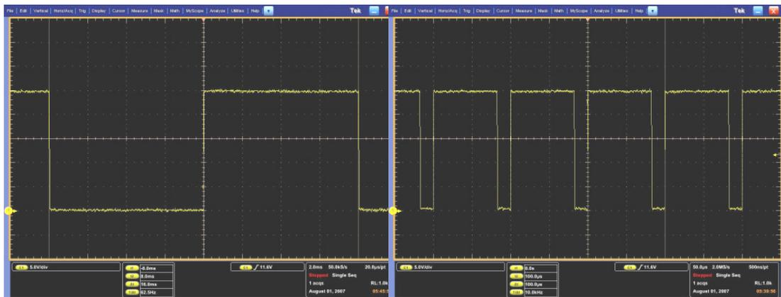
Abb. 36: 16ms Periodendauer (62,5Hz) links und 0,2ms Periodendauer (5kHz) rechts gesamter Signalverlauf
