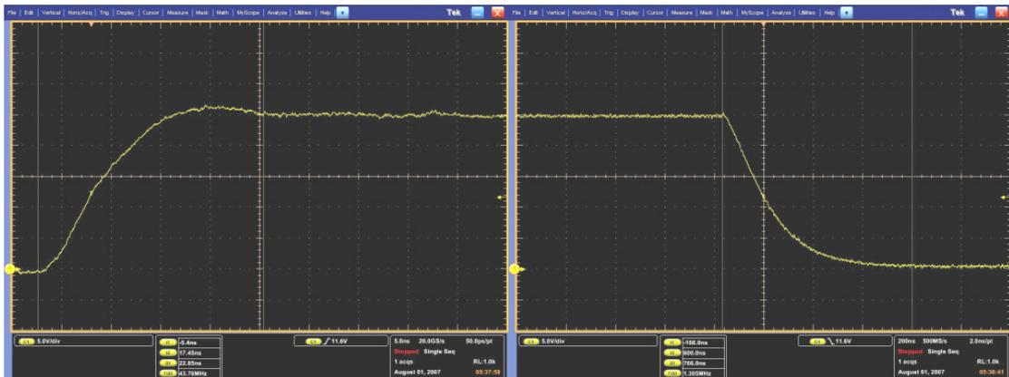
Abb. 35: 16ms Periodendauer (62,5Hz); pos. u. neg. Flanke; mit TK an 909Ω gemessen
