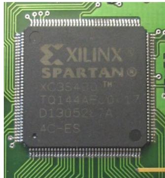
Abb. 17: FPGA der Firma Xilinx [ 16]
