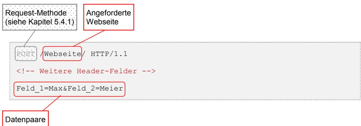
Bild 5-12: Syntax eines POST-Requests
