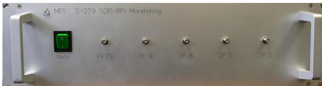
Abbildung 8.32: Frontplatte des Einschubs mit Netzschalter, FFTS-Ausgang und vier ZF-Eingängen
