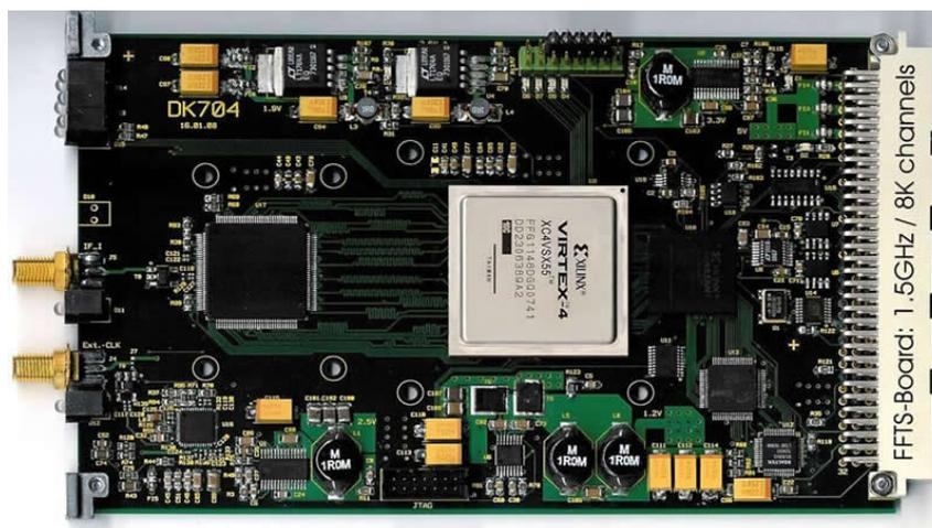
Abbildung 8.1: FFTS-Board mit Xilinx Virtex-4 FPGA und 8192 spektralen Kanälen [31]
