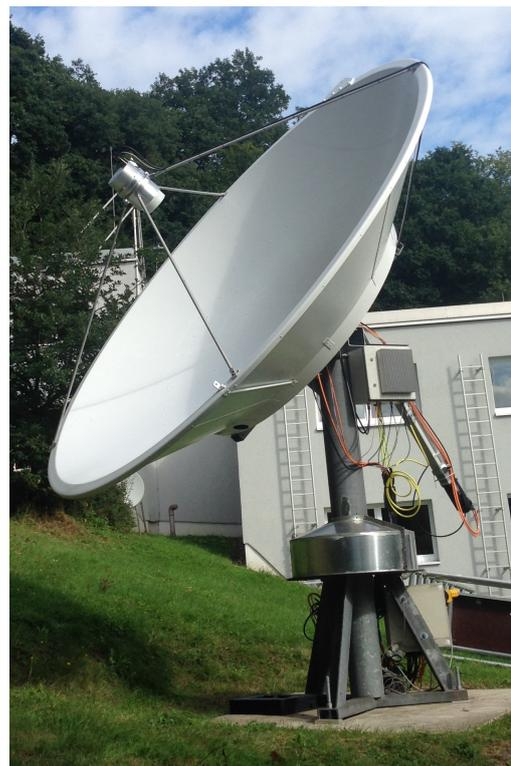
Abbildung 2: Bild des 4-Meter-Radioteleskops
