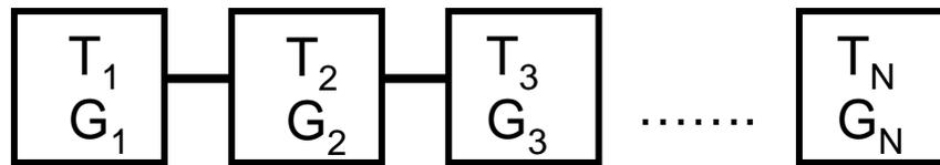
$$T = T_1 + \frac{T_2}{G_1} + \frac{T_2}{G_1 * G_2} + \dots + \frac{T_N}{G_1 * G_2 * \dots * G_{N-1}}$$
